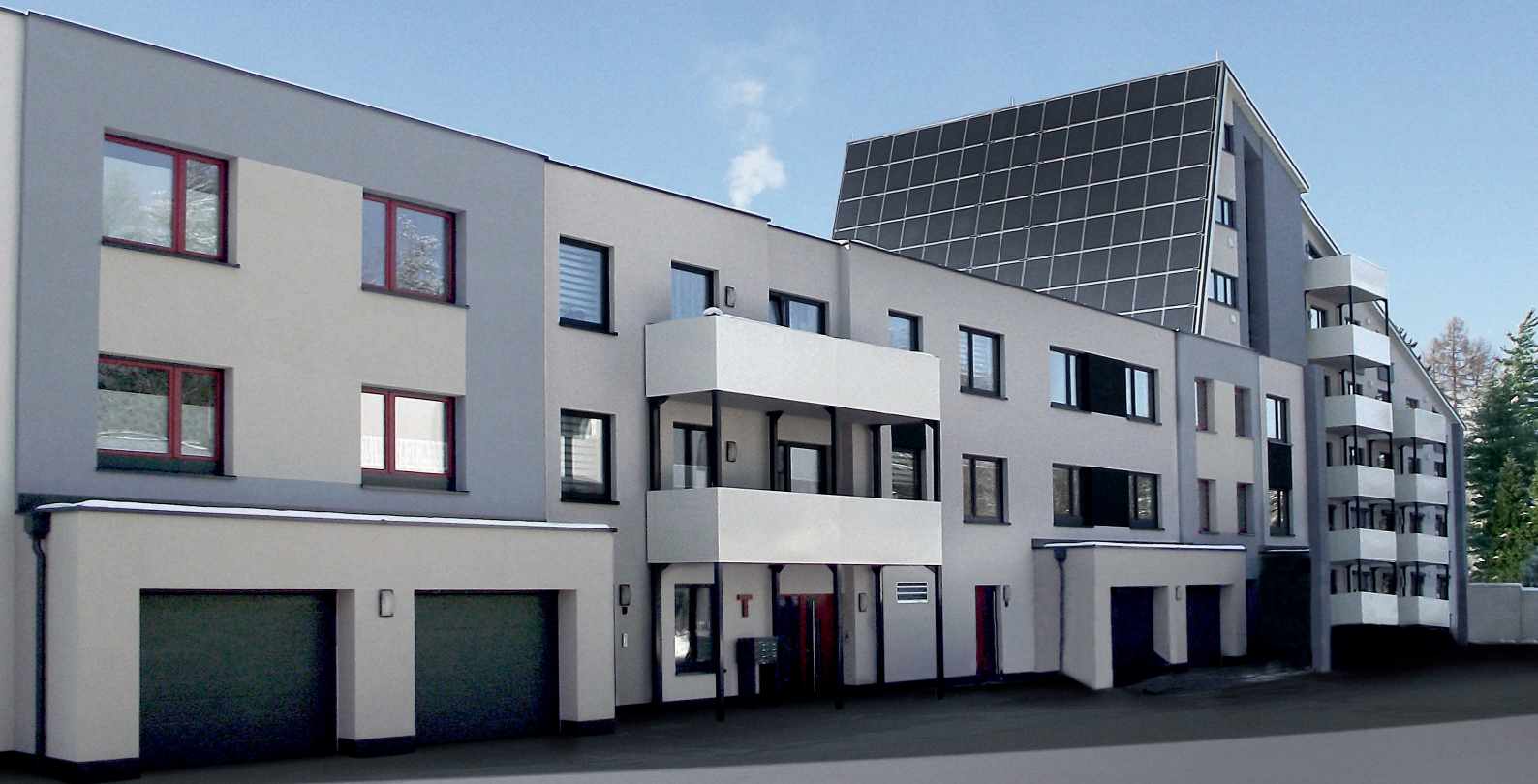
Waldidyll am Windberg, Zwickau: RETANOL®XTREME, RETANOL®EKA BLAU, Nippon SZ, CT-C20-F4-H45-S65, Belegreife: 7 Tage
